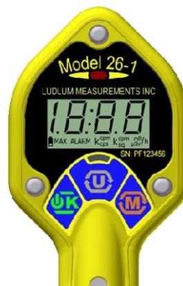
Puis l'appareil affiche la version de firmware et active la LED alarme. Si la LED alarme ne s'allume pas il est nécessaire de retourner l'appareil pour réparation. La figure 2 ci-dessous sert de référence.
