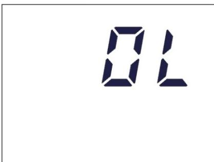
Figure 2.7: Detector Overload Alarm (Display Will Flash)
