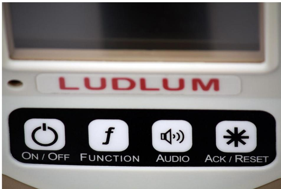
El instrumento está equipado con una almohadilla de cuatro botones, como se muestra arriba. Todos los controles del instrumento se ejecutan mediante estos cuatro botones. Cada botón etiquetado tiene un conjunto de operaciones que desempeña.
