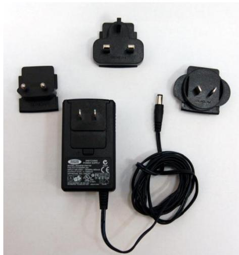
La entrada del cargador de energía recibe 108-240 V entre 50/60 Hz. La salida es de 15.0 V a 1600 mA. Para asegurar la carga apropiada, no use cargadores con otras especificaciones diferentes a las de arriba. Se ha construido dentro del instrumento Ludlum todo para proteger la carga de los circuitos que monitorean los niveles de batería, y las baterías NIMH de una sobre carga.
