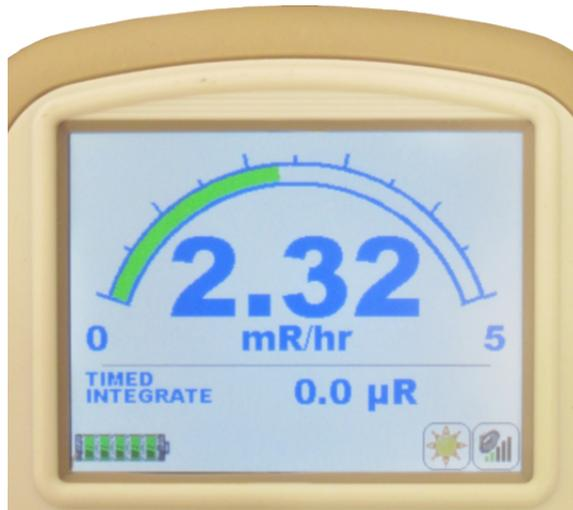
El modelo Ludlum 9DP-1 es un equipo con una LCD a color que mejora el entendimiento del usuario con las lecturas, funciones y estado de operación del instrumento, comparado con otras tecnologías de pantallas. La LCD utiliza una distribución de mapa de bits para asegurar un arreglo óptimo de toda la información disponible.
